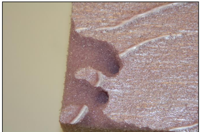
Figur 3. Gnag av stokkmaur i uskadet isolasjon. I laborerietesten begynte maurene å gnage etter noen timer og gangsystem var etablert etter 2 døgn.
